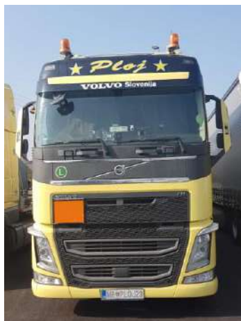
Slika 4: Prikaz oranžne table na vlečnem vozilu, ki opozarja, da gre za prevoz nevarnih snovi.
